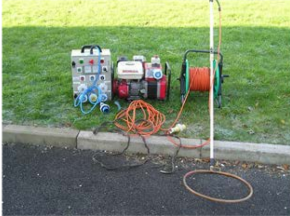
ຮູບທີ 3: ອຸປະກອນການຫາປາແບບເອເລັກໂຕຣ ຫຼື ແບບໄຟຟ້າ ທີ່ສາມາດຕິດໄວ້ນໍ້າແຄມແມ່ນໍ້າ ຫຼື ຕິດໄວ້ທາງຫຼັງ ກະເປົາເປ້
