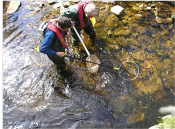
ຮູບທີ 3: ອຸປະກອນການຫາປາແບບເອເລັກໂຕຣ ຫຼື ແບບໄຟຟ້າ ທີ່ສາມາດຕິດໄວ້ນໍ້າແຄມແມ່ນໍ້າ ຫຼື ຕິດໄວ້ທາງຫຼັງ ກະເປົາເປ້
