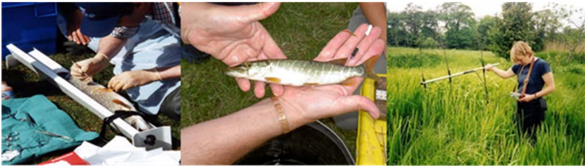
Hình 4 : Cấy thẻ âm thanh vào cơ thể của cá (ảnh trái), thẻ âm thanh cùng với ăng ten bên ngoài (ảnh giữa) và thiết bị cầm tay để phát hiện tín hiệu (ảnh phải) (MRC 2019, Phối hợp giám sát môi trường tại các dự án thủy điện dòng chính sông Mekong).
