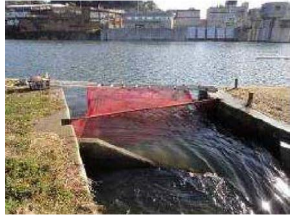
Hình 3. Lấy mẫu dạng lưới phễu tại lối ra đường cá (MAFF, Nhật Bản).
